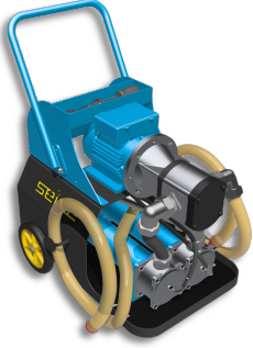
RK 91.2 - 2 Filtre Opsiyonu 25 ve 10 mikron ile gelen 2 filtreli model.
