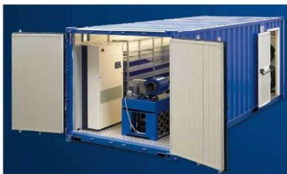
İşletmeniz için ihtiyacınız olan Rakorlu Hidrolik Hortumları Şantiye şartlarına uygun hızlı bir şekilde üretim yapmanıza imkan sağlayacak şekilde tasarladığımız mobil atölyeler ile tanışın. Şantiyedeki işlerinizin sona ermesi halinde hızlı bir şekilde diğer şantiye ye kolaylıkla taşınabilmektedir.
