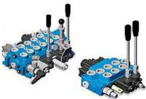
Monoblok ve Dilimli, On-Off ve Oransal Spoollu yön kontrol valfleri hidrolik yağ akışına manuel, pnömatik, elektrik veya hidrolik uyarı ile kumanda edilebilirler. Genellikle orta basınçlı hidrolik sistemlerde, mobil araçlarda kullanılırlar. Çok farklı bağlantı ölçüleri ve spool tipleri mevcuttur.
