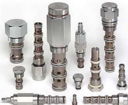
Hidrolik Cartridge valfler ile hidrolik sistemlerde kullanılan Cetop valfi uygulamaları gerçekleştirmeye imkanı vardır. Bu valflerin en büyük avantajları kompakt yapılarından dolayı küçük hacimlerde yüksek debi ve basınçtaki hidrolik sistemleri çalıştırabilme imkanı sunmasıdır. Cartridge valflerin maksimum çalışma basıncı 420 Bar olup 1-2000 lt/dak. debi aralığında üretim programında vardır. Bu tip valfler hat tipi uygulamarda kullanıldığı gibi çok fonksiyonlu sistemlerdede kullanılmaktadır.
