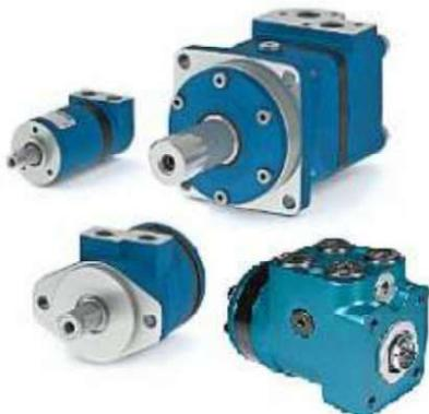
Orbit Motorlar orta sınıf yük ve hızların kontrolü için kullanılırlar. 10cm<sup>3</sup>/dev – 2000cm<sup>3</sup>/dev debi aralığı ve 0-420 bar çalışma basıncı aralıklarında üretimi vardır. Mobil araçlar için kullanılmaktadır.
