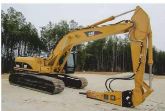
Ataşman Kiti tasarım mühendislerimiz iş makinenizin orjinallliğini bozmayacak şekilde kaynaksız ve ekstra delik işlemi olmaksızın iş makinenize özel olarak tasarlanan ekipmanlar ile montaj işlemleri yapılmaktadır. Bu sayede iş makinanızın garantisini etkileyebilecek bir durum oluşmamaktadır.
