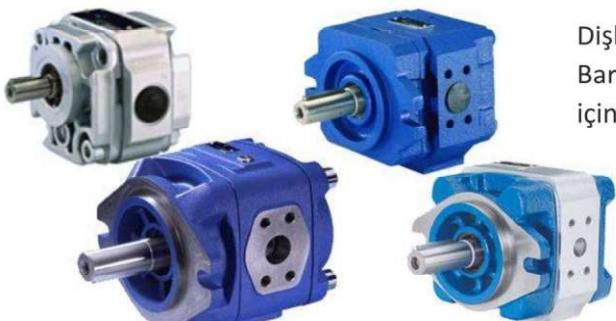
Dişli Pompalar 0,75cc ile 150cc aralığında üretilmektedir. Genellikle 0-210 Bar basınç aralığında çalışmaktadır. Yapıları gereği uygun fiyatlı oldukları için tercih edilirler.
